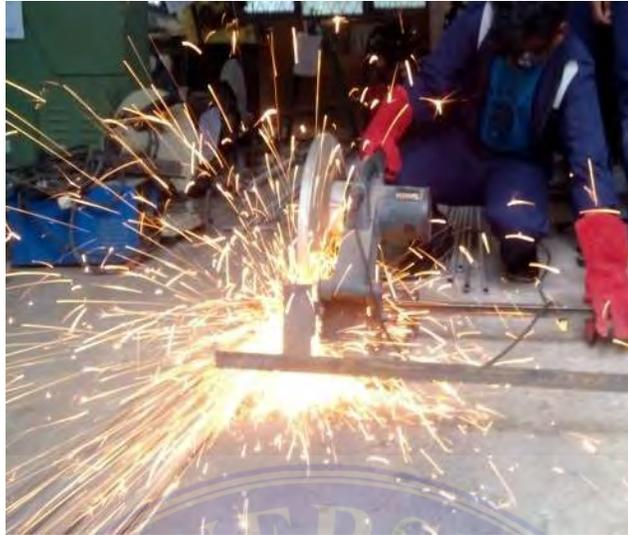
**Gambar 2. 12 Pemotongan Menggunakan Gerinda**
