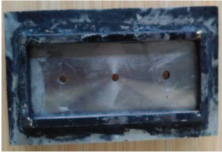
Gambar 5. Dudukan cetakan pipa komposit serbuk arang
