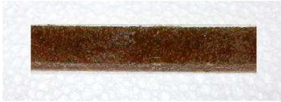
Gambar 5. Spesimen uji statik bending batang pohon pisang
