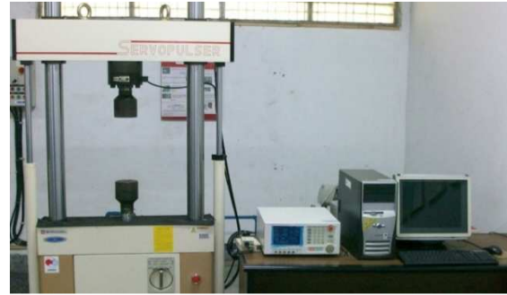
Gambar 2. Alat uji bahan jenis Shimadzu Servopulser 100 kN
