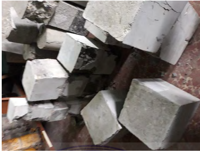
Gambar 14. Sampel beton yang sudah diuji
