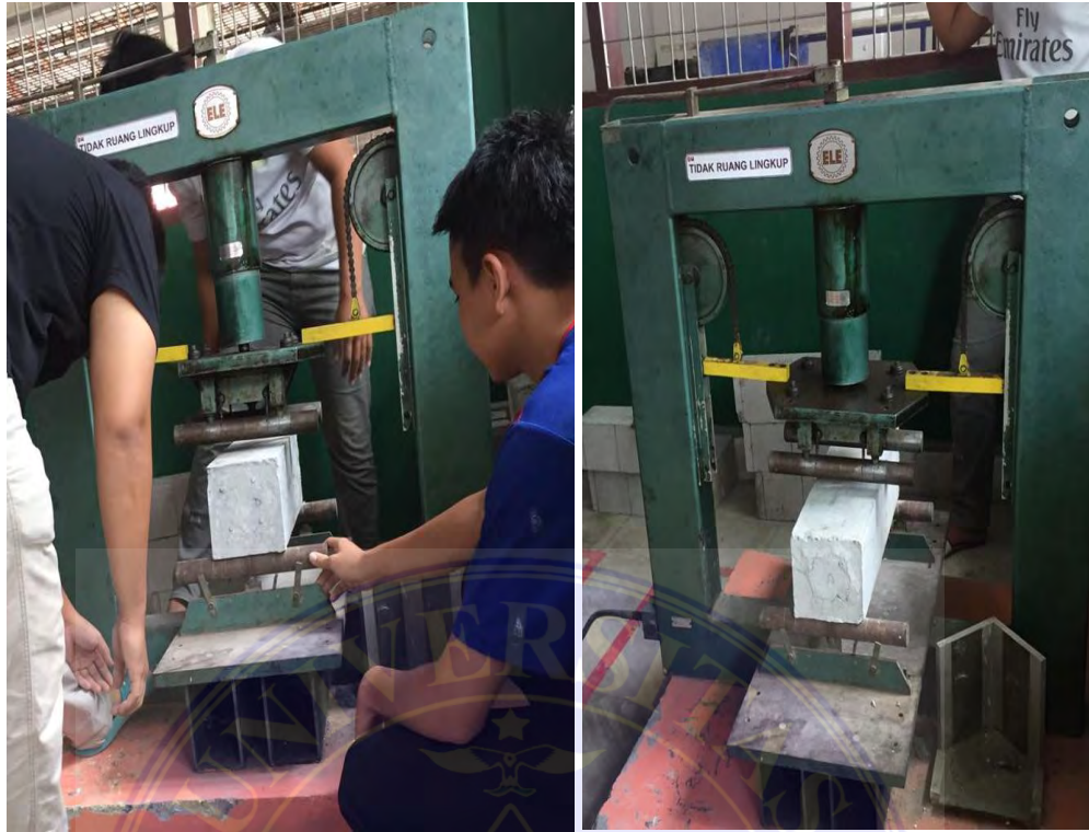
Gambar 15. Pengujian Kuat Lentur Balok
