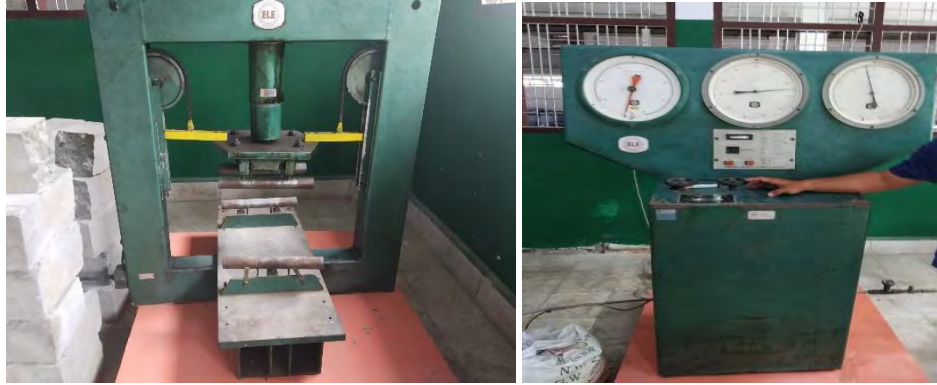
Gambar 3.1 Alat uji kuat lentur
