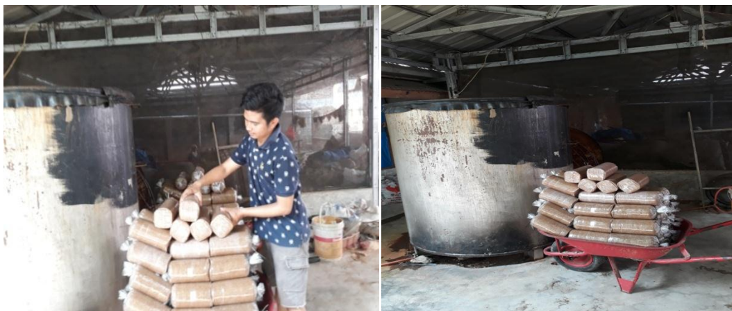
Gambar 6. Sterilisasi Baglog Jamur Tiram dengan Menggunakan Oven Drum
