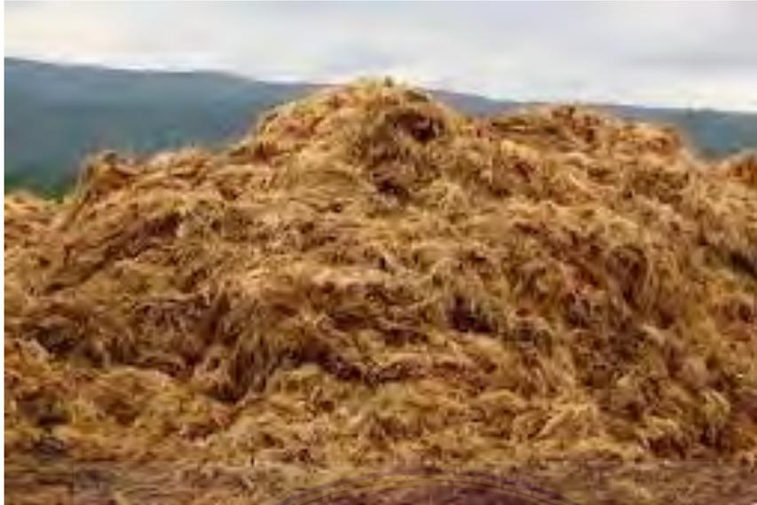
**Gambar 2.12 Serabut (fiber) Kelapa Sawit**
