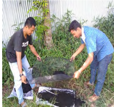
Gambar 4. Penggilingan biochar secara manual serta menggunakan blender dan pengayakan
