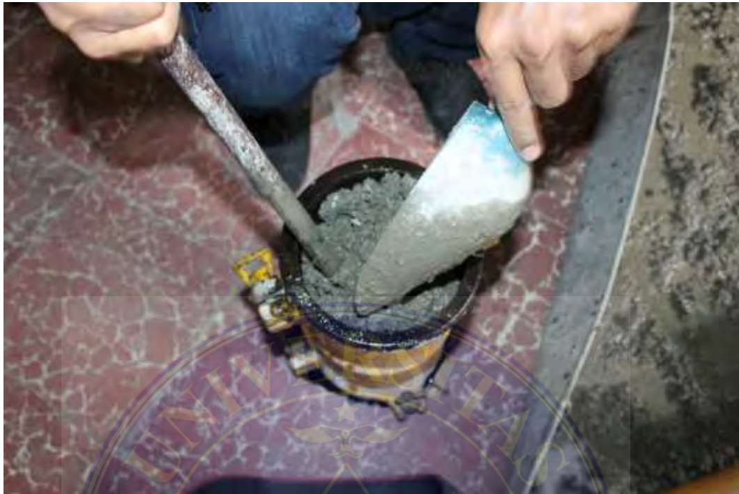
16. Proses memasukkan mortar kedalam cetakan dan selanjutnya dilakukan pengerojokan terhadap beton segar
