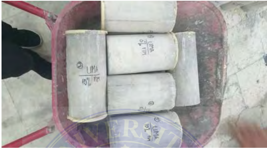
21. Hasil benda uji setelah diuji kuat tekan
