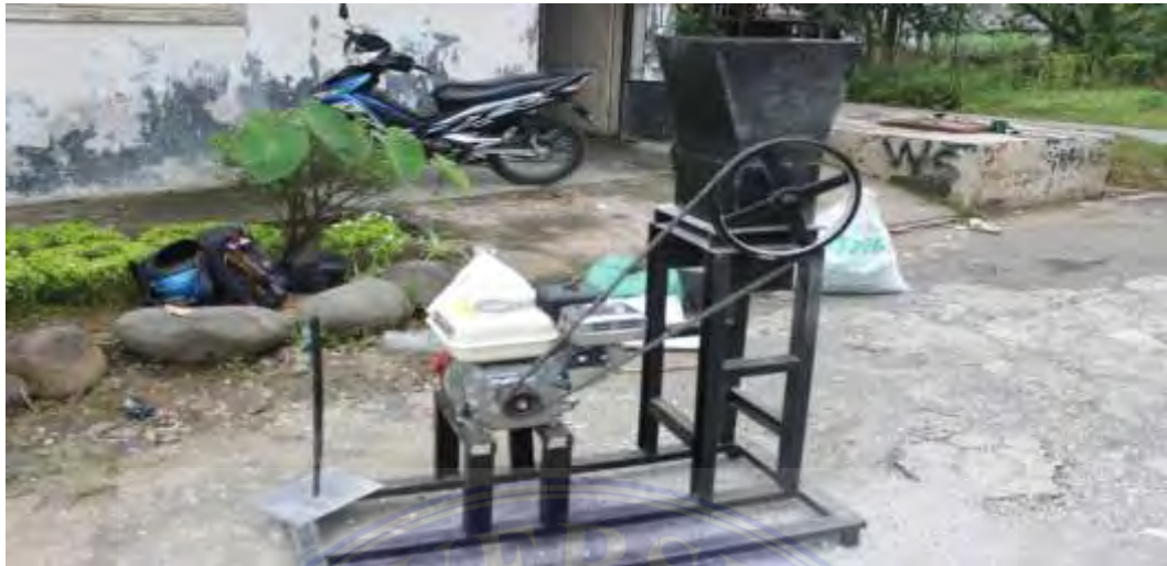
11. Proses penghalusan kulit kerang menggunakan mesin pencacah
