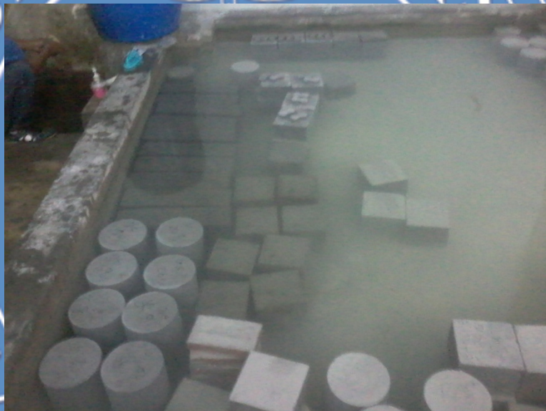
Gambar 3.3 Kolam Air Untuk Perawatan Benda Uji
