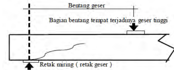
Gambar 2.14 Retak miring pada balok beton bertulang Sumber : Buku Teori dan Desain Plat Balok Beton Bertulang oleh Ali Asroni 2017
