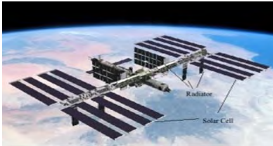
Gambar 2.5 Penggunaan panel surya pada satelit luar angkasa
